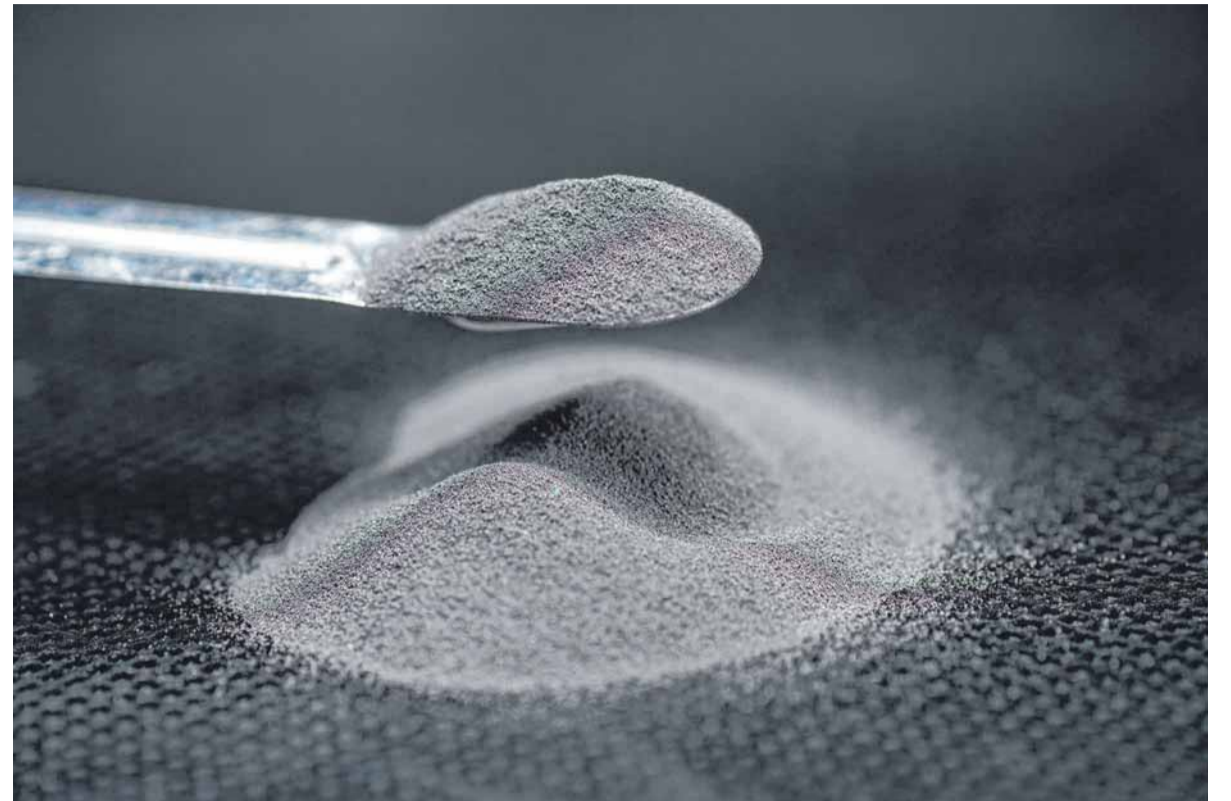
So sieht das selbst entwickelte Stahlpulver aus, bevor es im 3D-Drucker verarbeitet wird. FOTO: HELMUT FEIL / KOLIBRI METALS
